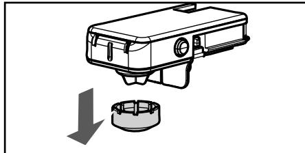
**11** Поверните и поднимите крышку Cappuccinatore, чтобы отсоединить ее от корпуса Cappuccinatore.
