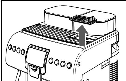
**i** Примечания: если в отделение не насыпан предварительно намолотый кофе, вы получите только подачу воды; если доза чрезмерная, и будут насыпаны 2 или более мерки кофе, машина не будет производить подачу кофе. В этом случае машина также выполняет цикл впустую и направляет порошкообразный кофе в контейнер для отходов.
